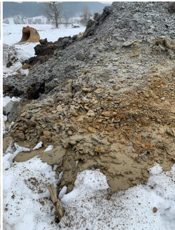
Foto 10: Schurf S5, Aushub Kies, nass
