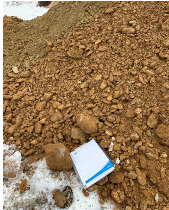
Foto 2: Schurf S1, Aushub Kies
