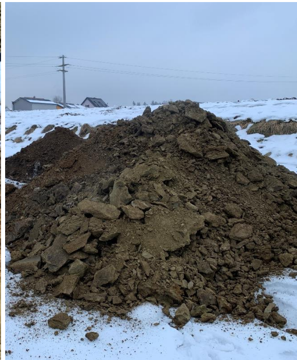
Foto 6: Schurf S2, Aushub Lehm
