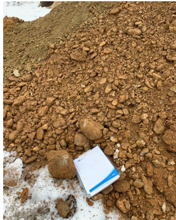
Foto 2: Schurf S1, Aushub Kies
