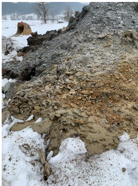
Foto 10: Schurf S5, Aushub Kies, nass
